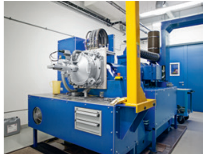
links // FZG-Test zur Belastbarkeit von Getriebeölen. Wann treten Schäden an den Zahnflanken der Prüfzahnräder auf? rechts // Prüfstand „GK3“ in Wedel: Im runden Prüfkopf muss Getriebeöl in Verbindung mit Original-Kupplungsscheiben seine Leistungsfähigkeit beweisen.
